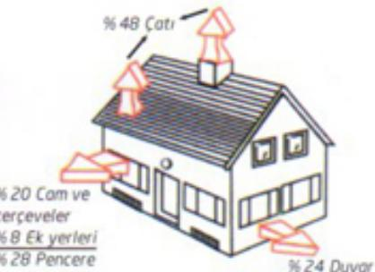
Bu ısı kayipları eğer binanın cephe ve çatı izolasyonu yapılrsa ortadan kalkacaktır.
